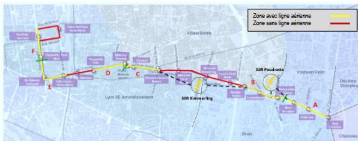
Figure 22 : Linéaire de Ligne Aérienne de Contact (LAC)
